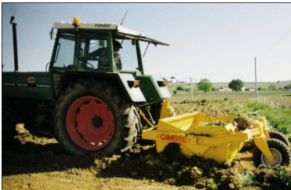
Chargement de la terre : le réglage de profondeur s'effectue par la longueur du 3 ème point.
